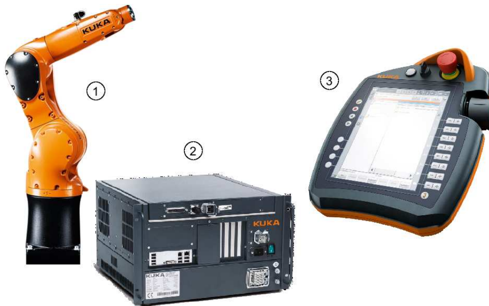
Rysunek 2: Elementy systemu robota: 1 - Robot KR 6 R900 sixx (KR AGILUS), 2 - Szafa sterownicza KRC 4, 3 - Panel operatorski (KUKA smartPAD).
